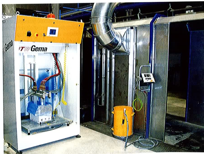
La centrale de poudrage de Surfatech.
